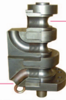
直徑模 (拉彎) (Bending Die/Draw Bending)
